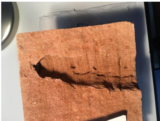
Figuur 9 Result Trias dynamic nozzle
